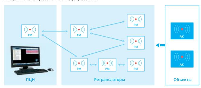
На рисунке представлен другой пример организации радиосетей ОКО на частотах F1 и F2 с помощью радиомодемов-ретрансляторов , имеющих несколько радоканалов. Радиосеть построена таким образом, что прием извещений от объектов осуществляется на частоте F2, ретрансляция – на частоте F1.
