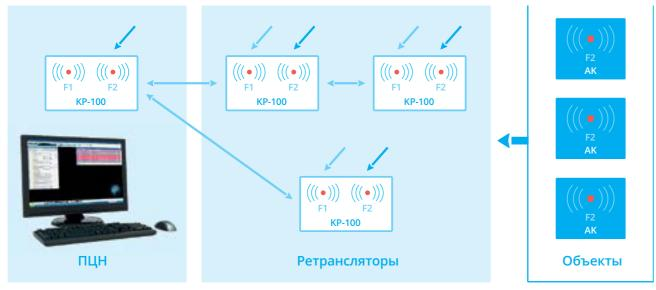
Все ретрансляторы принимают извещения от объектового оборудования (АК) на частоте F1. Ретрансляторы, имеющие прямую связь с ПЦН, могут транслировать извещения на ПЦН напрямую. Ретрансляторы, не имеющие прямой связи с ПЦН, ретранслируют извещения по цепочке. Ретрансляция осуществляется на частоте F2 в симплексном режиме.
