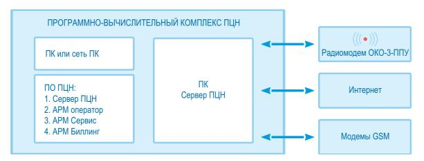
Основой пульта ОКО-3-ПЦН является программно-вычислительный комплекс, состоящий из персонального компьютера (ПК) и программного обеспечения (ПО ПЦН). Количество ПК на ПЦН зависит от количества рабочих мест для операторов ПЦН (АРМ оператор), сервисных инженеров (АРМ Сервис) и менеджеров договорного отдела (АРМ Биллинг).
